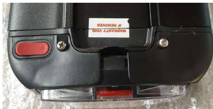
Ensuite extraire le bloc arrière en le faisant pivoter un peu sur l'angle opposé aux vis. Ne pas hésiter à tirer assez fort pour 'déclipser' ce bloc.
